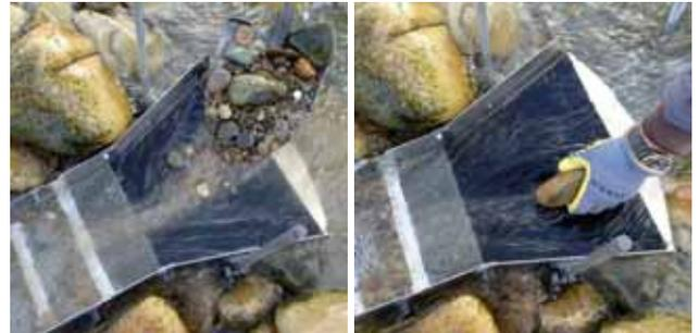
Aufschütten von gesiebttem Material: Homogenes Abfließen des Materials ist möglich, die Schleuse setzt sich nicht zu:
