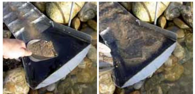
Gleichmäßiges Abfließen und mittige Konzentration mit dem Ergebnis, dass sich erste Goldflitter auf der Gummimatte und in der Flitterfalle zeigen:
